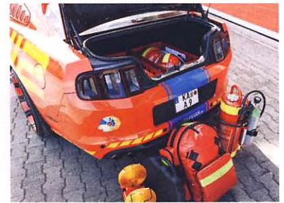
Die Ausstattung umfasst unter anderem Defibrillator, Notfall-Rucksack sowie Hochdrucklöcher.
